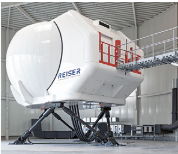
Beim künftigen Helikoptersimulator lässt sich das Cockpit auswechseln.
