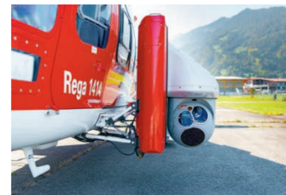
Das IR/EOS-Suchsystem: eine hoche sensible Wärmebildkamera und optische Sensoren.
