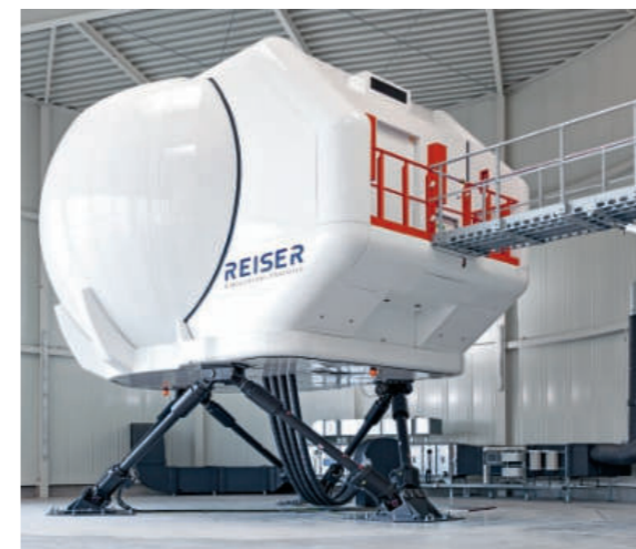
Beim künftigen Helikoptersimulator lässt sich das Cockpit austauschen.
