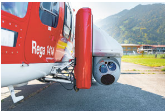
Le dispositif IR/EOS : une caméra thermique ultra-précise et des senseurs optiques
