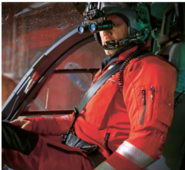
Les nouvelles jumelles de vision nocturne offrent un champ de vision plus large et des contrastes plus marqués.
