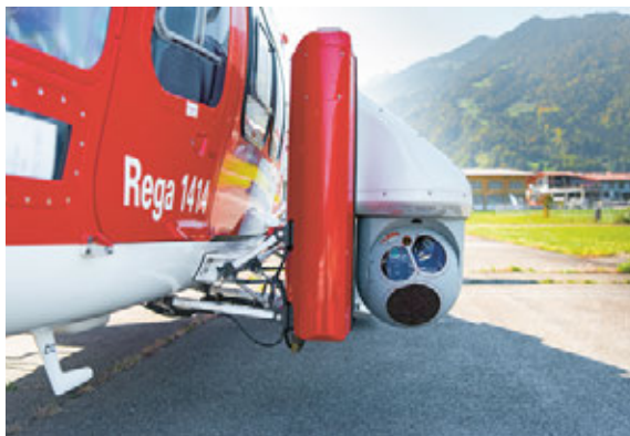
Il sistema di ricerca IR/EOS: una termocamera altamente sensibile e sensori ottici.
