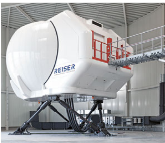
Il futuro simulatore di volo è dotato di una cabina di pilotaggio intercambiabile.
