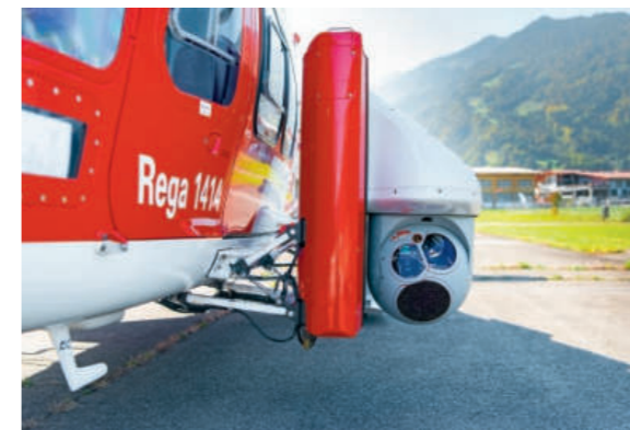
Il sistema di ricerca IR/EOS: una termocamera altamente sensibile e sensori ottici.
