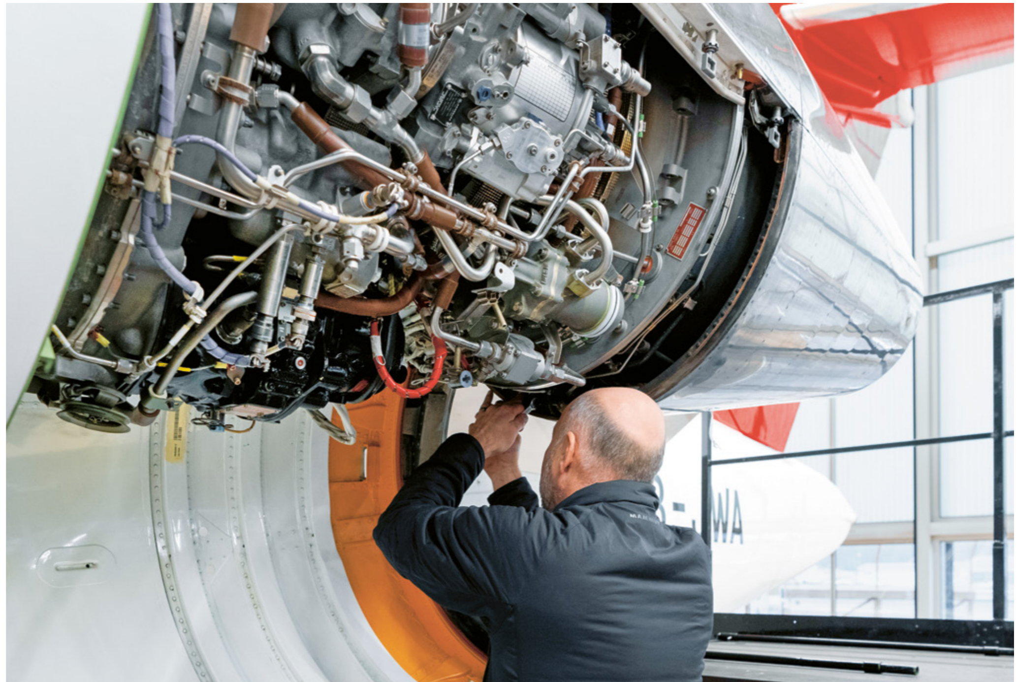
Prüfen, reparieren und gemäss Vorgaben warten: Alle sechs Monate widmen sich die Jet-Mechaniker dem Triebwerk des Ambulanzjets.
