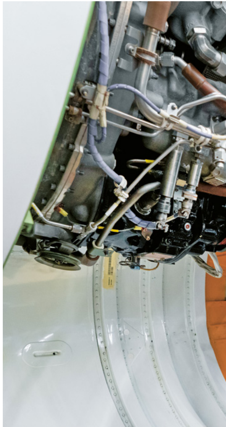
Controllo, riparazione e manutenzione secondo le norme: ogni sei mesi, i meccanici di jet si dedicano al motore del jet ambulanza.
