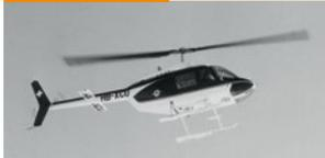
**Bell 206A, erster Helikopter mit Turbine** Der «Jet-Ranger» HB-XCU verfügt zwar über eine Turbine, aber nicht über eine Rettungswinde. Bergrettungen ohne Landemöglichkeit sind nur mit dem Fixtau möglich.
