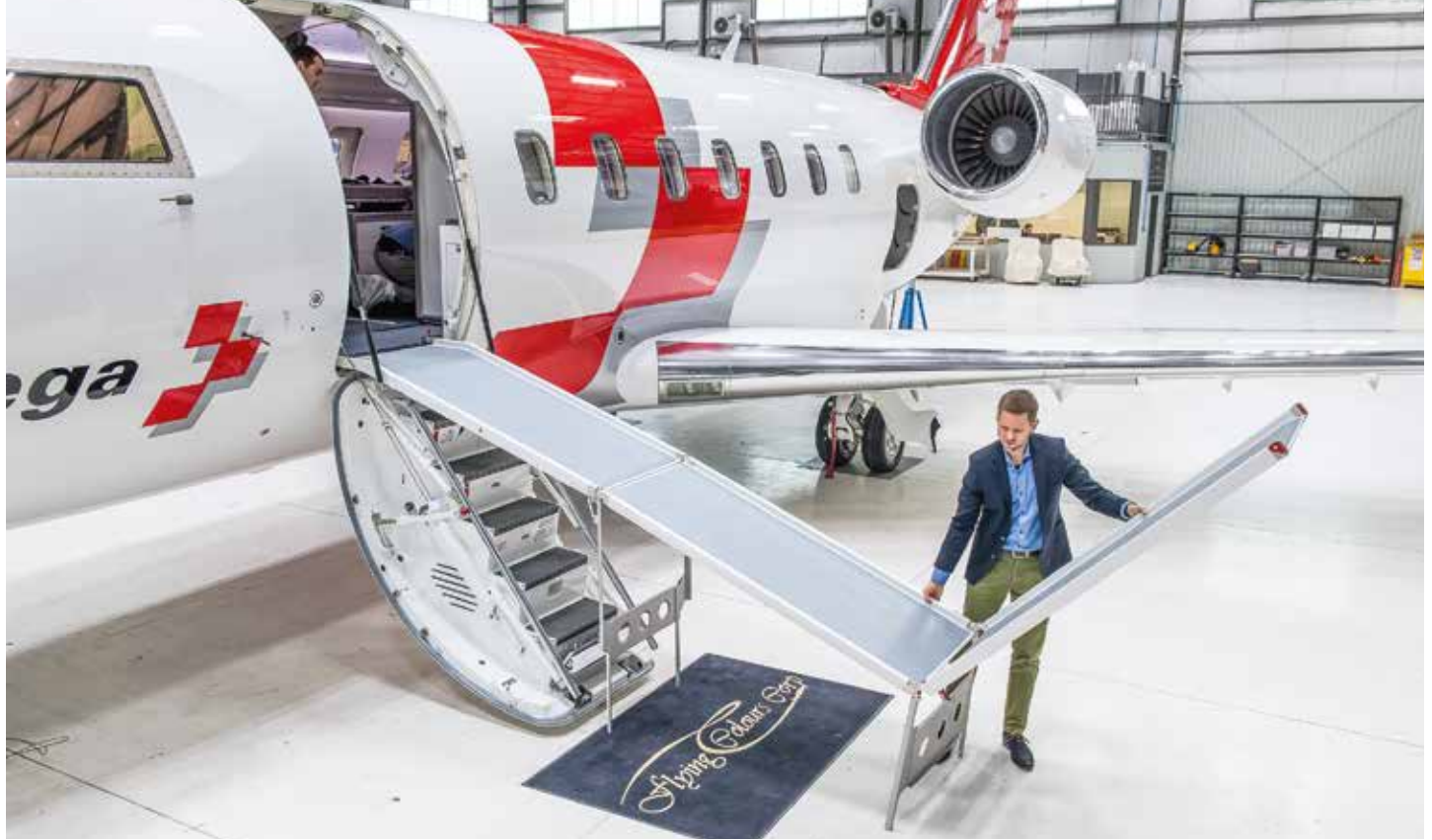
Evoluzione costante: la nuova rampa per il carico e scarico dei pazienti senza scosse.
