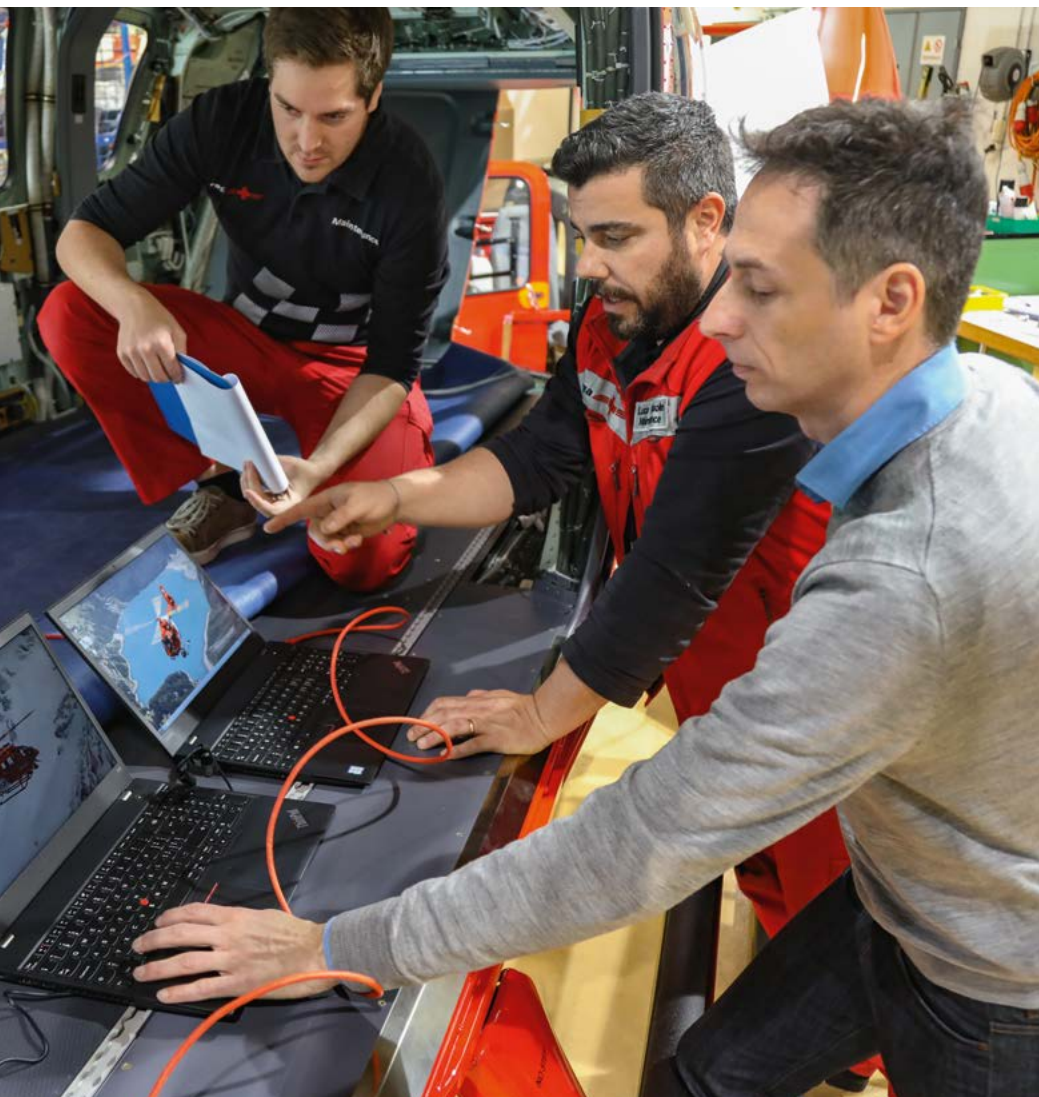
Digitalisation de la maintenance au hangar : un contrôle de fonctionnement est réalisé sur l'ordinateur de maintenance à bord de l'hélicoptère de sauvetage H145.
