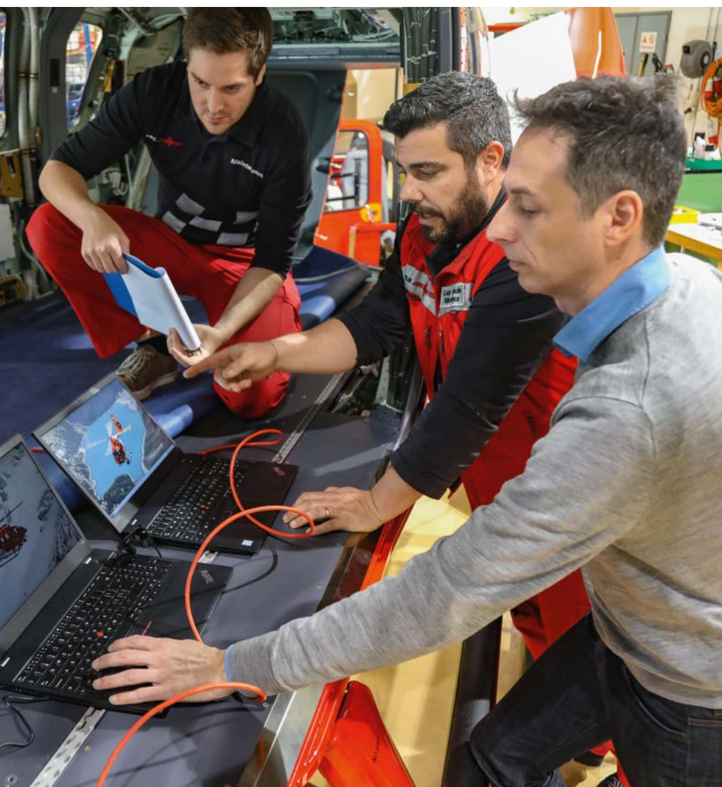
Procedure digitalizzate nell'hangar: sui portatili per la manutenzione viene controllato il funzionamento nell'elicottero di soccorso H145.
