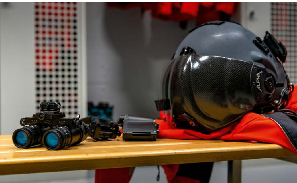
Binokular und Akkupack werden vor dem Nachtflug am Pilotenhelm befestigt.
